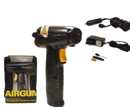
Compresseur sans fil multi-usages pour un gonflage efficace de balles et de ballons, réglage et lecture de la pression en Psi ou Bar. Fonctionne avec batterie (9,6 V - pression 10 Bar) ou peut être directement branché sur l'allume cigare (12V). Puissance : 180W. Batterie 11,1V. Fourni avec adaptateurs balles, ballons et vélos.
